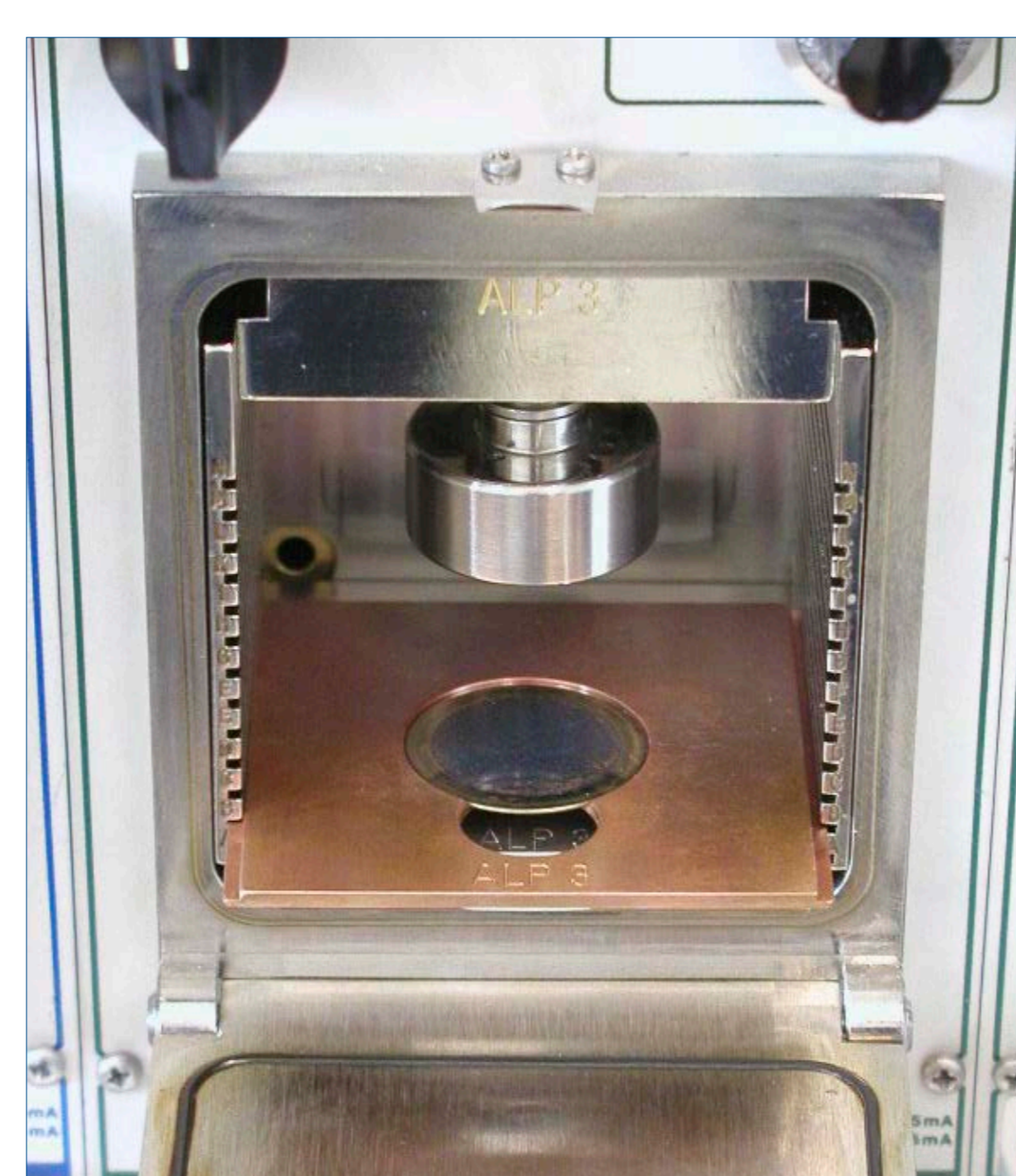
Stahlplättchen nach elektrolytischer Abscheidung - Messpräparat
