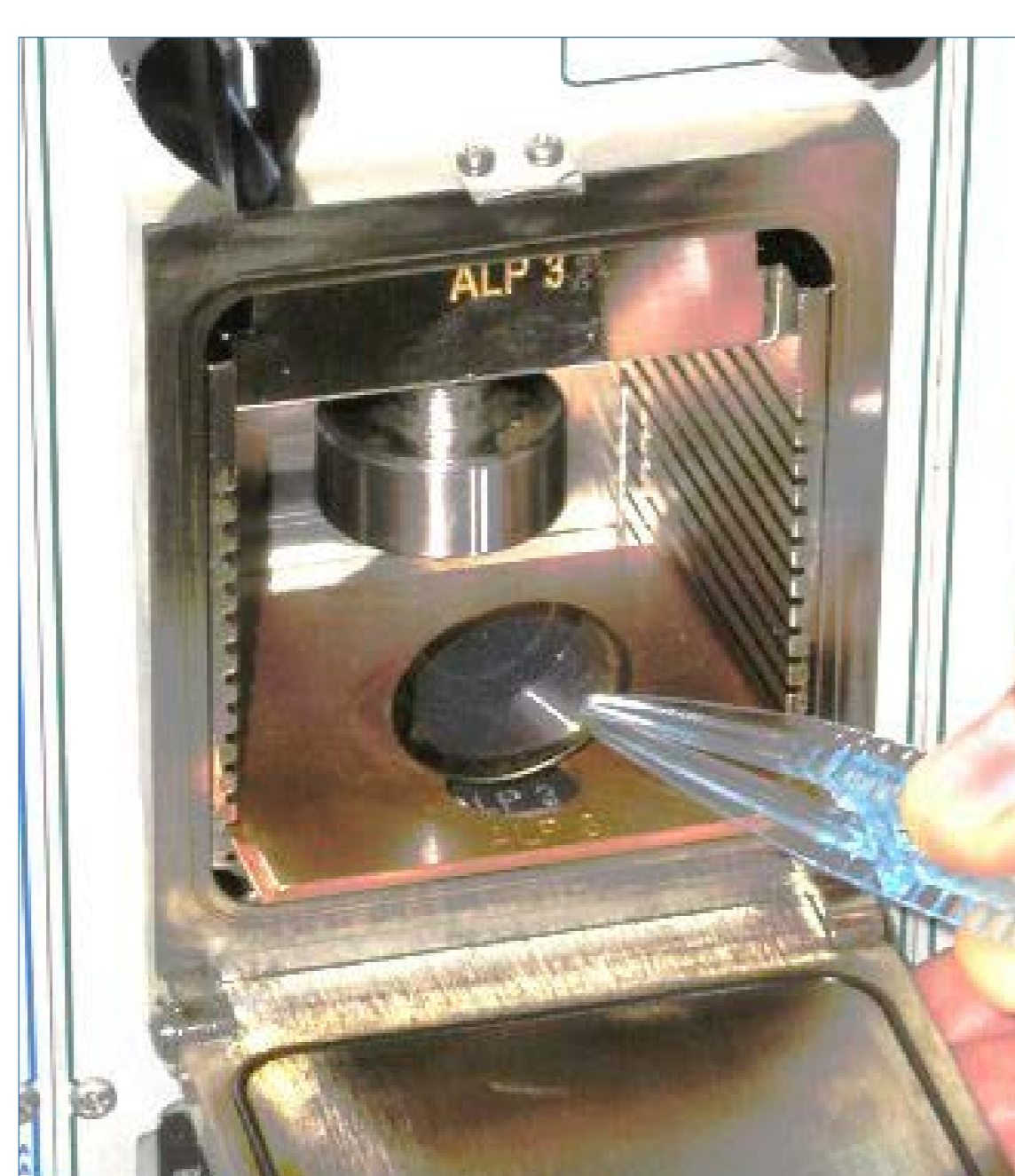
Alpha-Messkammer mit Detektor und Messpräparat
