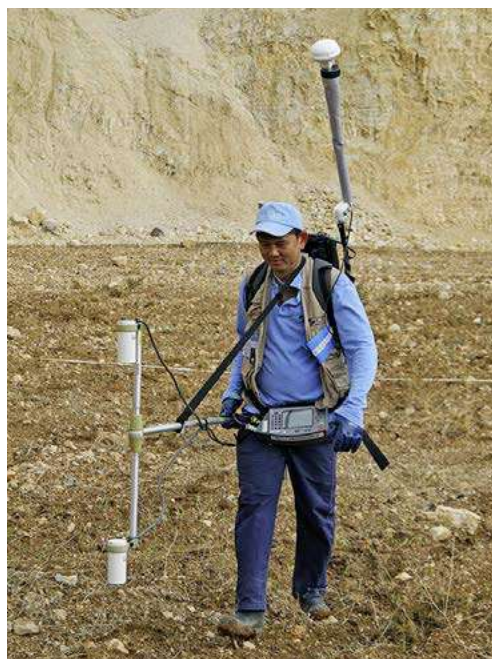
Messungen des Magnetfelds der Erde
