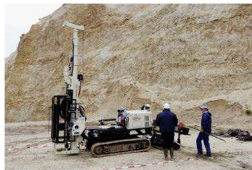
Subsoil-Gas-Sampling zur Messung diverser radioaktiver Edelgase
