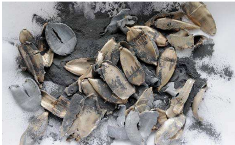
Starke Fragmentierung und Pulverisierung der Projektile aus einem Lamellenkugelfang
