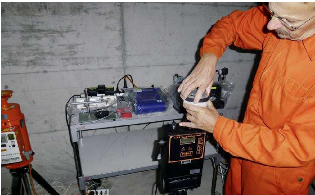
Einsatz der Luftstaub-Probenahmegeräte im Feld
