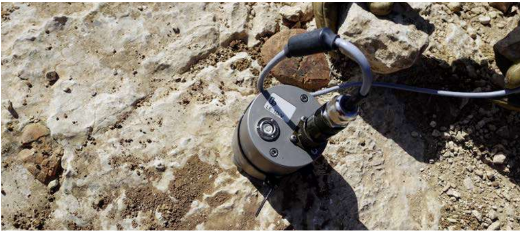
Seismik-Sensoren werden über das gesamte Inspektionsgebiet verteilt
