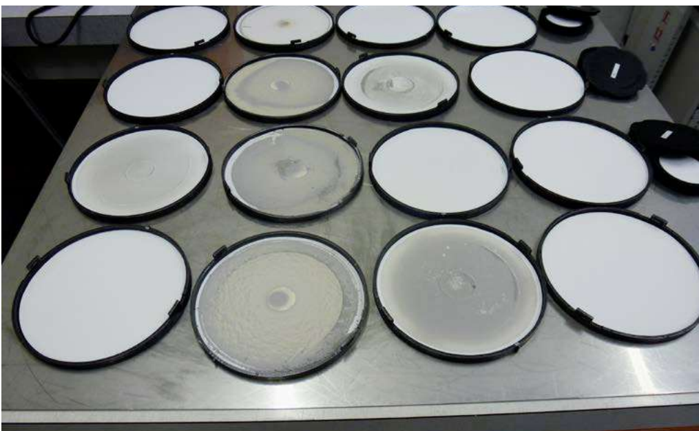
Luftfilter mit verschiedenen Staubbelastungen
