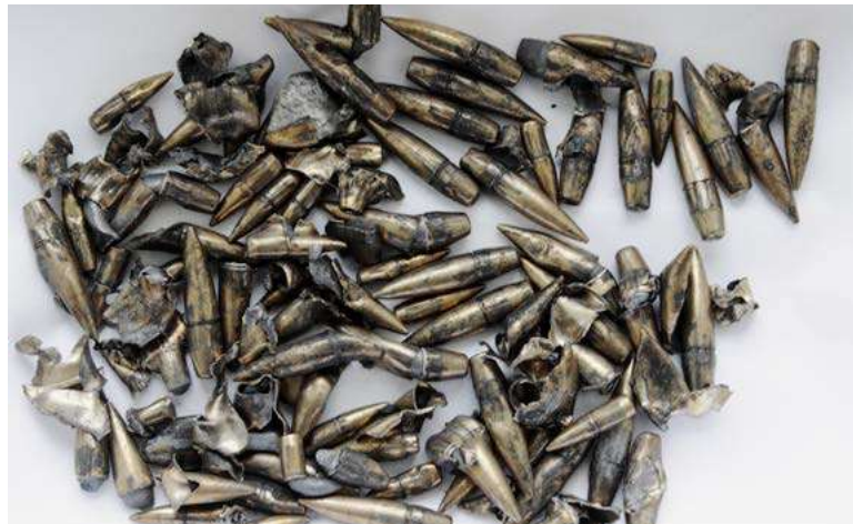
Wenig deformierte Projektile aus einem Granulatkugelfang
