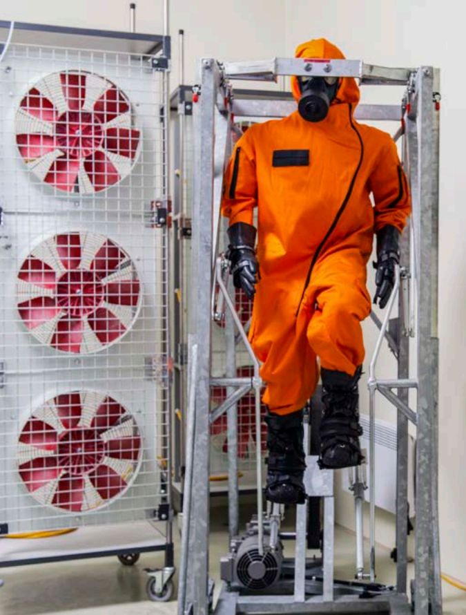
Figure 1: Gauche: Chambre d'essai MIST avec simulation du vent et mannequin articulé au Laboratoire Spiez, droite: placement de 33 échantillonneurs passifs.
