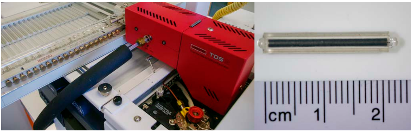
Figure 2: Droite: Twister® et gauche: l'unité de désorption thermique couplée à une GC-MS au Laboratoire Spiez.
