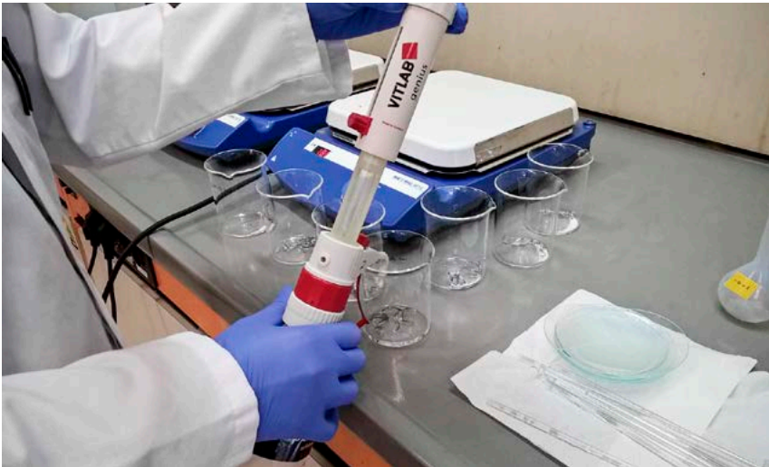
Abbildung 2: Zugabe der hochreinen Salpetersäure zu den Bleiprobe in Quarzgefäßen
