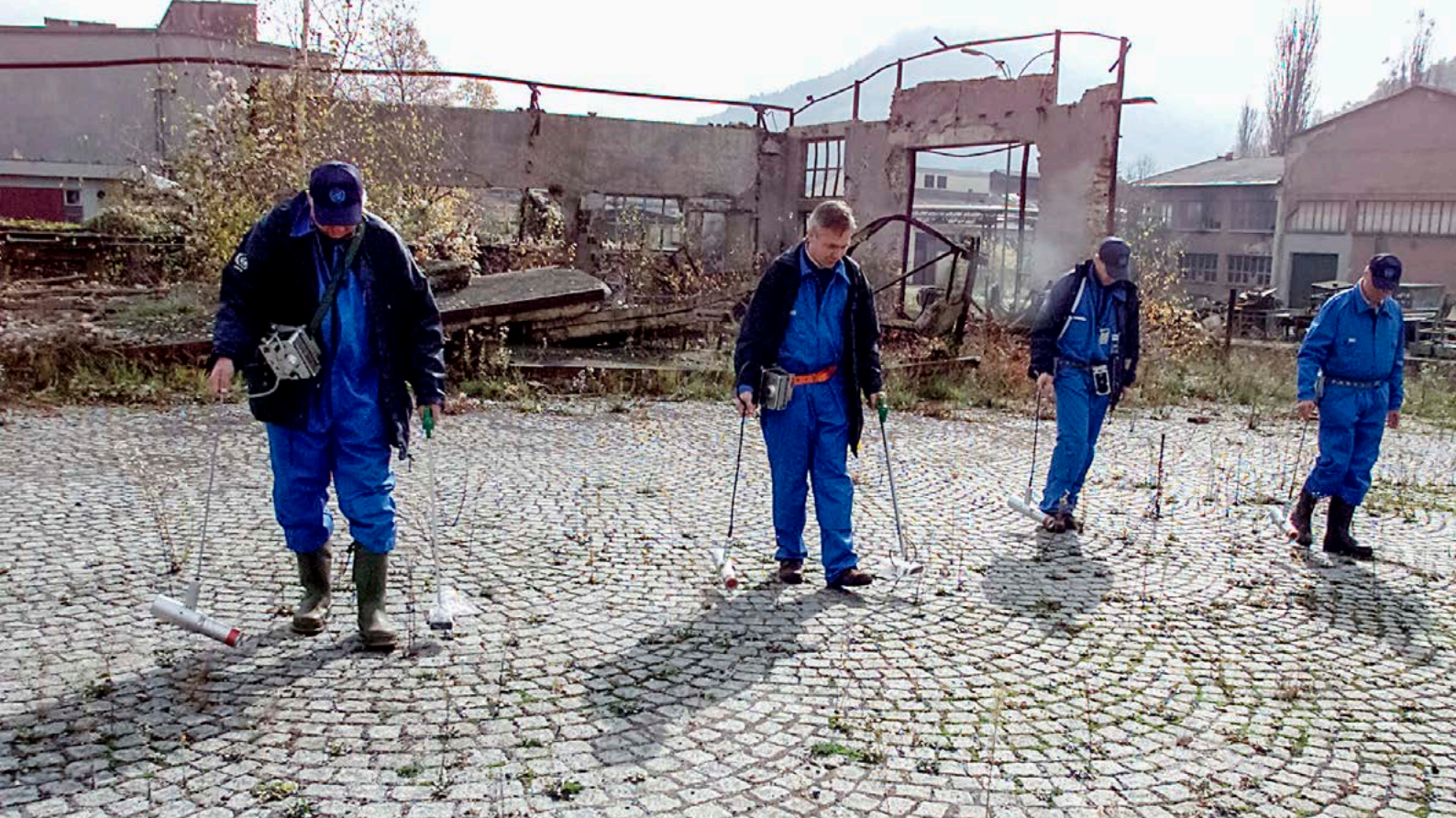
Gefahrenherde werden mit Strahlungsmessgeräten lokalisiert
