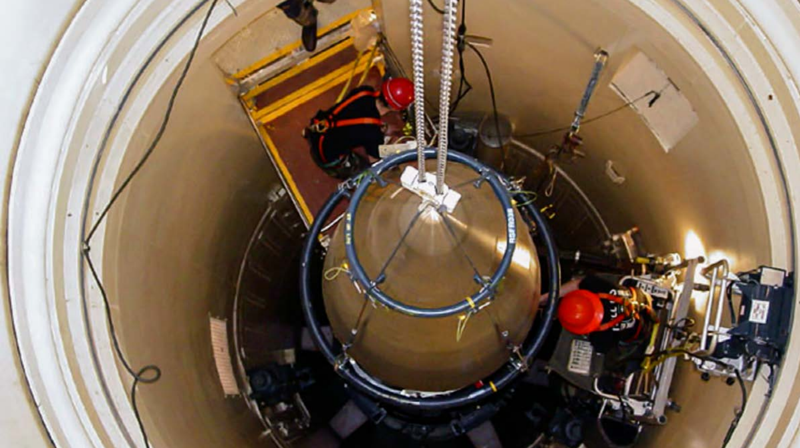
Ein Wartungsteam der US-Luftwaffe entfernt den oberen Teil einer Interkontinentalrakete mit einem nuklearen Sprengkopf auf der Malmstrom Air Force Base, Montana.
