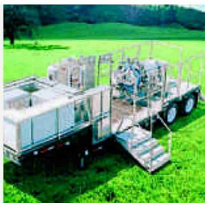
Explosionskammer (rechts auf Anhänger) zur Zerstörung von Chemiewaffen.
