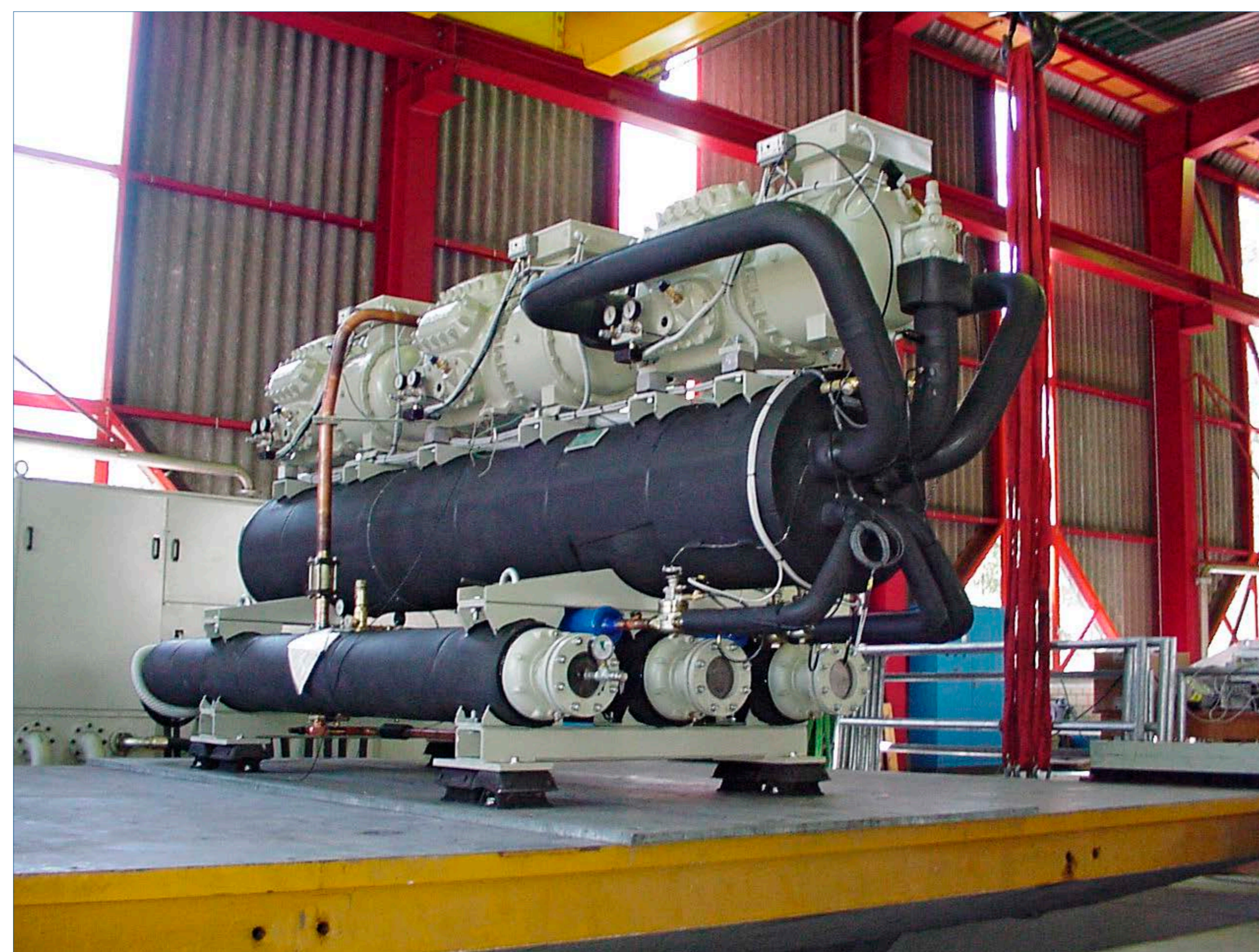
Prüfobjekt (Kältemaschine), Z-Achse
