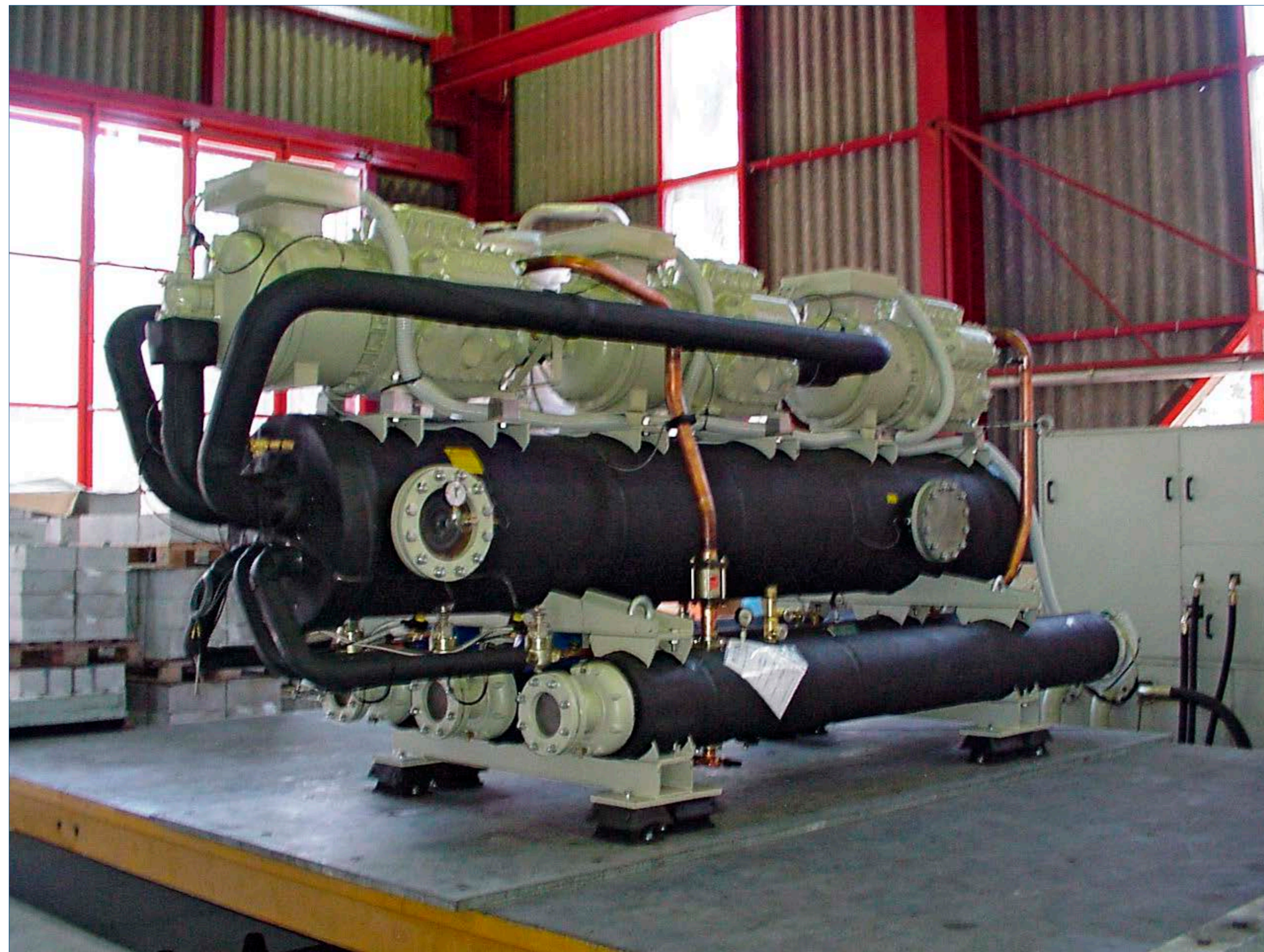
Prüfobjekt (Kältemaschine), Z-Achse
