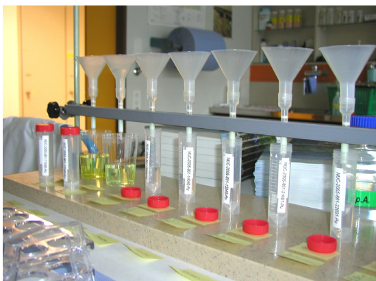
Bild: Pu wird chromatographisch abgetrennt.
