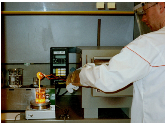
Bild: Die Boratschmelze wird in Salpetersäure gegossen
